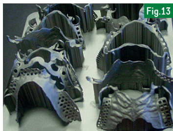
Fig.13 : Châssis pour PAPM imprimés par frittage Laser.
