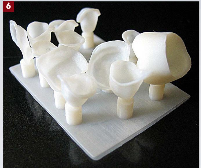
6 Utilisation de la résine Detax pour la réalisation de guides, gouttières, provisoires de différentes teintes.
