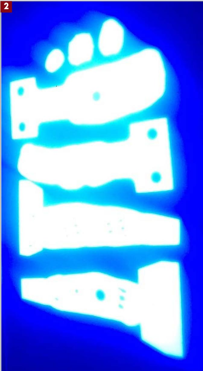
Technologie DLP : Projection lumineuse en forme via UV LED.
